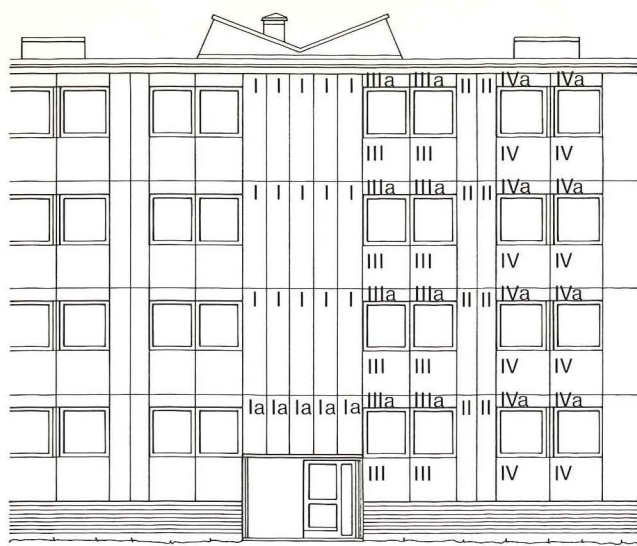
Figur 8.23. Komponentopdeling i indgangsfacade. Beskrivelse af komponent: Stiv isoleringsplade af PIR med strukturoverflade af puds med polypropylenfiberarmering. Kantskinner af tyndpladestål fastlimet til isolering. Kantskinner anvendes til at udføre en to-trins tætning mellem komponenter samt til at fastgøre komponenterne til ydervæggen.
